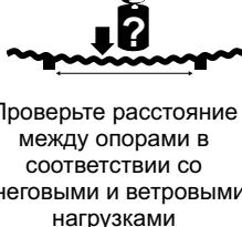
Проверьте расстояние между опорами в соответствии со снежными и ветровыми нагрузками
